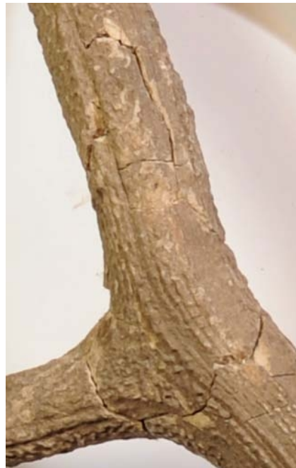
Heißkleberklebungen mit großen Lücken, die zu Aufbaufehlern führten.
